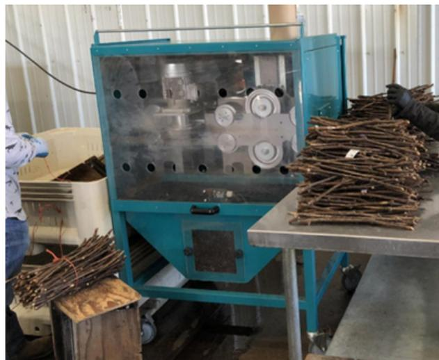
Figura 11. Una máquina desmotadora utilizada para quitar las yemas de las cañas de portainjertos.
