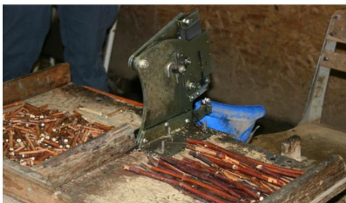
Figura 10. Máquina injertadora con vástago (lado izquierdo) y madera de patrón (lado derecho).
