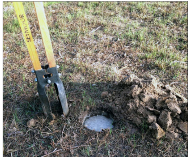
Figura 5. Un hoyo excavado apropiadamente para una prueba de percolación.
